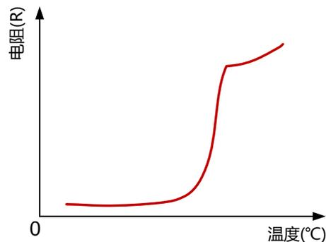
图 2 PPTC 电阻温度曲线
