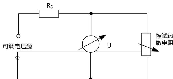
图 9  $I_{hold}$ ， $I_{trip}$ ， $V_{max}$ ， $I_{max}$  最大动作时间测试电路图
