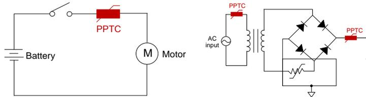
图 5 电机保护 图 6 交流电源保护
