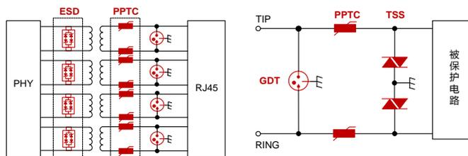
图 7 1000M RJ45 接口保护图 8 RJ11 接口保护
