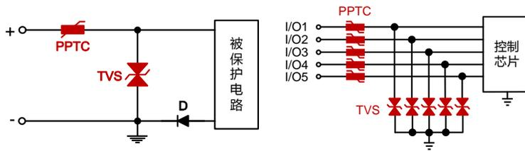
图 3 直流电源保护图 4 I/O 接口保护
